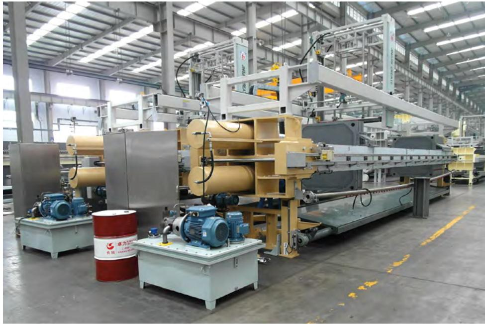
Стандартные компоненты гидравлики — соленоидные клапаны, насосы, клапаны предельного давления, фитинги и т. д. — применяют с полуторным запасом по давлению. В стандартной комплектации они китайского производства, но по желанию заказчика могут быть любого производителя (например, Atos, Bosh — Rexroth, Parker).
