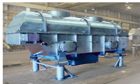
Сушилка в псевдооживленном слое (пивная дробина, послеспиртовая барда, песок)
