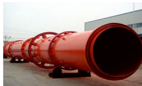
Барabanная сушилка (осадок «хвостов» ГОК, гальванических, металлургических производств)
