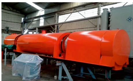
Двухшнековая сушилка (маслосодержащие осадки, отходы производства резины)
