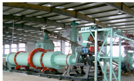
Барabanная сушилка (осадок стоков ЦБК, кожевенных производств и пр)
