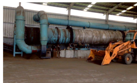
Барabanная сушилка (птичий помет, навоз, дигестат метантенков)
