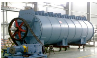
Роторная сушилка илового осадка после фильтр-пресса, СВ 50 %, 20 т/сутки
