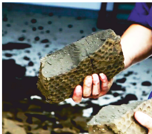
Обезвоживание осадка стоков водоподготовки
