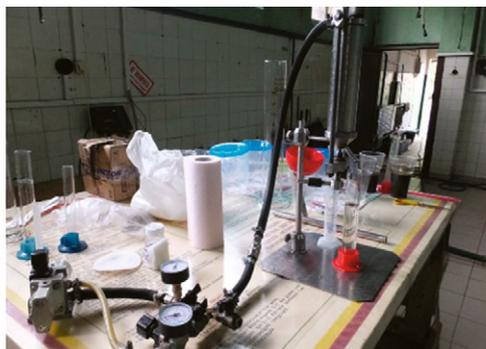
Рис. 45. Фильтровальная ячейка
