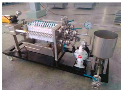
Рис. 50. Лабораторный камерно-мембранный фильтр-пресс
