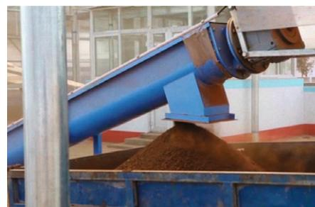
Рис. 42. Отгрузка высушенного осадка
