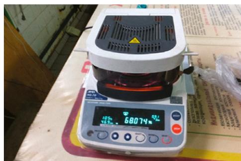
Рис. 49. Определение остаточной влажности кека
