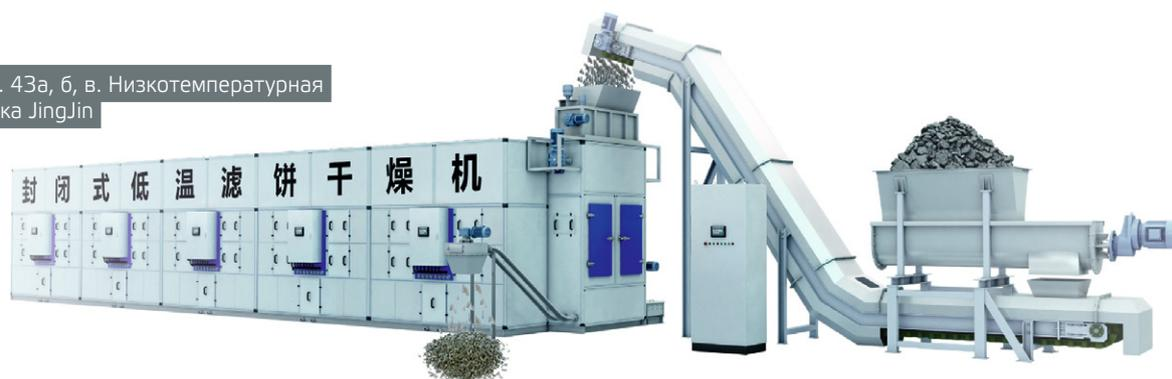
Закрытая низкотемпературная фильтровальная сушка осадка компании Jingjin использует принцип низкотемпературного испарения и конденсации. Кек транспортируется сетчатой лентой из нержавеющей стали, влага удаляется с помощью конвекционного горячего воздуха.
