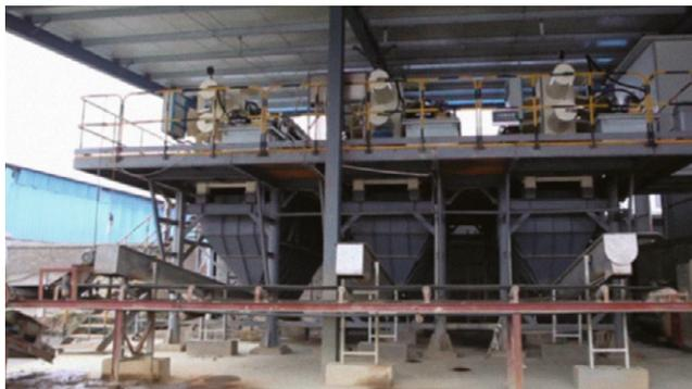
Рис. 32а, б. Фильтр-прессы JJ на проекте
