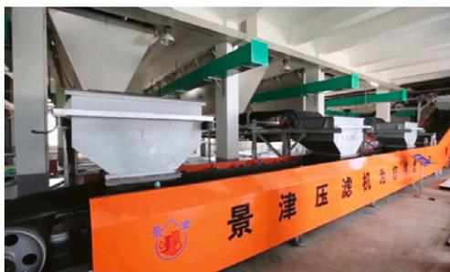
Рис. 39. Транспортировка осадка
